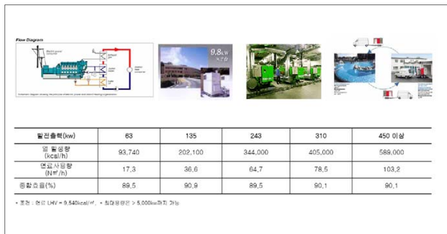
〈그림 7〉 가스엔진방식: 전기와 온수 생산, 주로 일반 건물 및 지역난방에 사용
