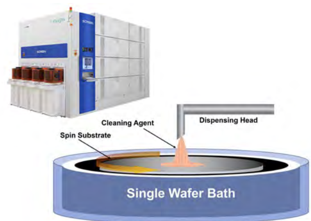
그림 273. 세정 공정용 Single Spray
