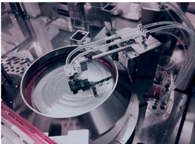
그림 139. PR Spin Coating 공정
