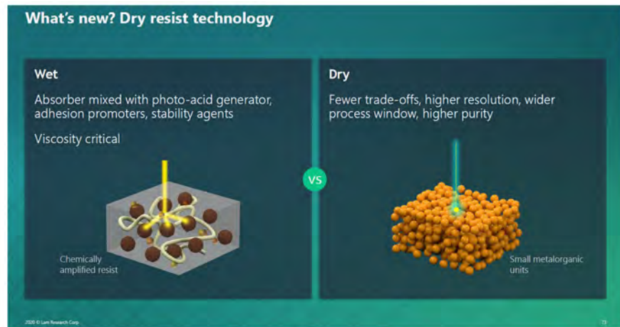
그림 172. Lam Research Dry PR 장점: Trade off 현상이 적고, 해상도가 높음
