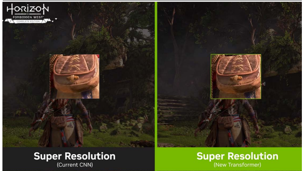
그림 6. DLSS의 기반 기술이 CNN에서 트랜스포머 아키텍처로 바뀌자 업스케일링의 화질 성능 향상
