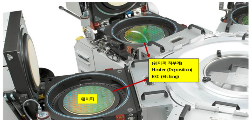
그림 40. 반도체 식각/증착 장비 내부
