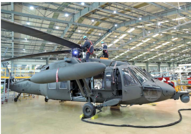
그림 12. 군용기 MRO; UH-60 창정비 수행 장면
