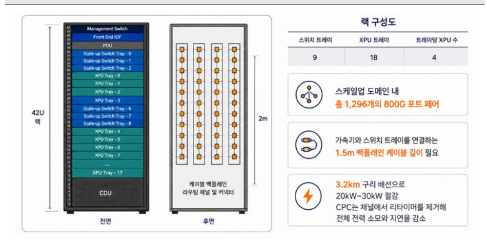
그림 67. 고밀도 AI 랙(72 XPU)에서 증가하는 단거리 구리 연결 수요
