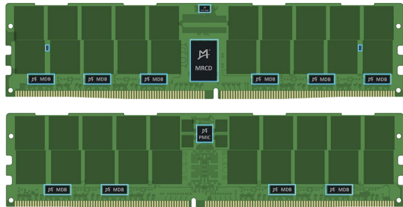
그림 28. DDR5 MRDIMM/MCRDIMM 구조도
